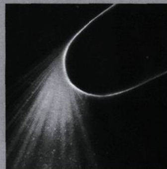
Prinzip der Glasfaser-Sensoren: Aus einer belasteten (gebogenen) Glasfaser tritt ein Teil des transportierten Lichts aus.
