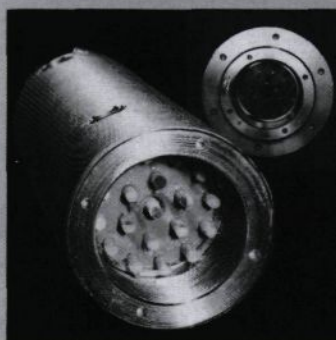
Hochleistungsverbundstab mit eingebetteten Polystal-Glasfasern.
