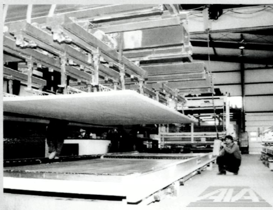
Blick in das 'Automatische Betonwerk': Palettenkran zum Abtransport der fertigen Deckenelemente in die Härtekammer.
