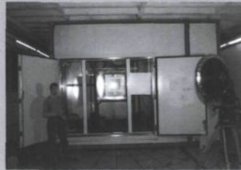
Der Zweiklimakammer-Fassadenprüfstand im Labor für Bautechnik, FH Köln, ermöglicht den Test geschoßhoher Fassadenteile unter reproduzierbaren Klimabedingungen.
