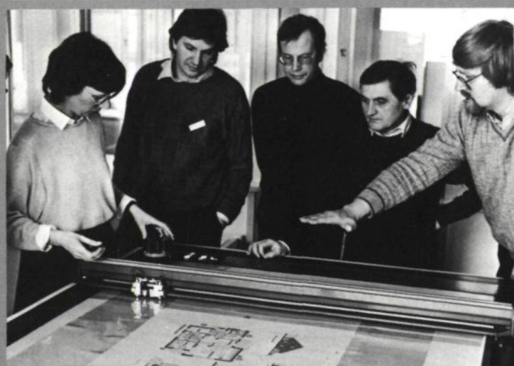
Blick auf die große CAD-Anlage mit 3 Arbeitsplätzen. Im Hintergrund der Din A 0-fähige Digitizer, der dazu dient, die Koordinaten fertiger Pläne aufnehmen zu können.
