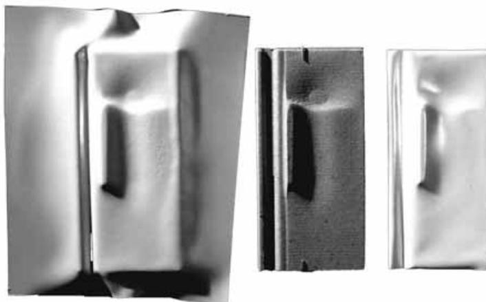
Die geformten Paneele wurden an den Kanten der Schalung abgeschnitten, an ihren Gratkanten zusammengeschoben und aneinandergeheftet. Dadurch entstand eine selbsttragende, kraftschlüssige Naht. Die Idee dazu stammt aus der in der Container-Industrie angewandten Welltechnik. Durch die statische Zusammenwirkung aus Form und Öffnung wird die Ornamentierung Bestandteil des einzelnen Panels.
