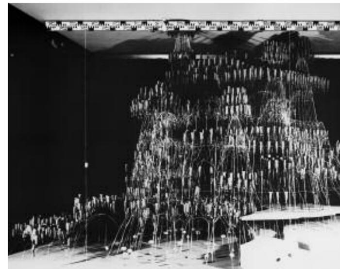
Um 180° gedrehte photogrammetrische Aufnahme des Rekonstruktionsmodells, welches vom Institut für leichte Flächentragwerke unter Leitung von Frei Otto und in Zusammenarbeit mit der Gaudí-Gruppe aus Delft angefertigt wurde.
