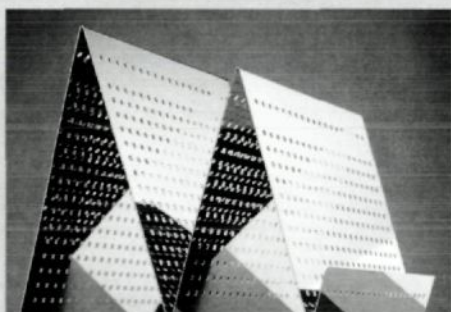
Oben: 'Big Birdie' von Jean-Marc da Costa für Serien Raumleuchten entworfen, beruht auf der Faltung eines Stahlblechs. Durch das Knicken entstehen der Hohlraum für die Niedervolt-Halogenglühlampe wie auch der Schirm. Alle weiteren Bauteile werden gesteckt und mit einer einzigen Schraube befestigt. Rechts: Für One Off entwarf Ron Arad eine Reihe von Stahl-Sitzgelegenheiten: 'London Papardelle', daneben: 'Up Like a Bear'. Unten rechts: Zeitschriftenständer aus perforiertem Edelstahl, Hersteller: Dürkop.
