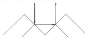
Um den Wirkungsgrad zu erhöhen, wird die Vorderseite der Zelle beschichtet oder pyramidenartig texturiert.
