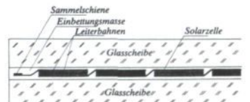
Querschnitt durch ein Solarmodul (AEG). Die Solarzellen sind zwischen zwei Glasscheiben in eine Kunststoffschicht eingebettet.
