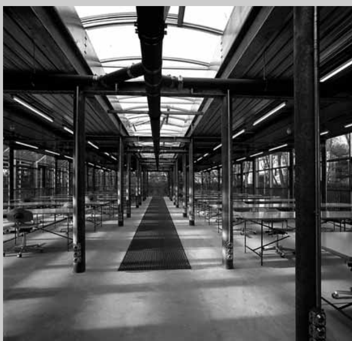
oben: Seminarraum Ebene 2; Oberlicht und Gitterrost in der Zwischendecke dienen der Entlüftung; rechts: Seminarraum Ebene 1
