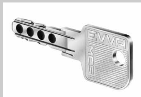
Links: Die Maulform der '3-Kurven'-Schlüsselspitze führt kurze wie lange Stifte beim Einschieben in die jeweilige Spur. Eine Profilleiste im Kern kontrolliert die Rückenprofilierung.
