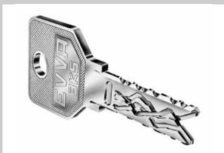
Links: Die Maulform der '3-Kurven'-Schlüsselspitze führt kurze wie lange Stifte beim Einschieben in die jeweilige Spur. Eine Profilleiste im Kern kontrolliert die Rückenprofilierung.
