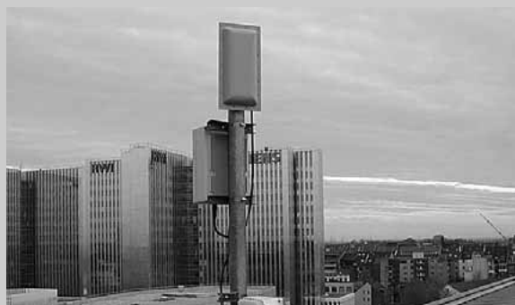
Oben: Richtfunkantenne zur Breitbanddatenübertragung von Firstmark; links darunter: Funknetz DMPA, Anschlußmöglichkeiten und Datenrate
