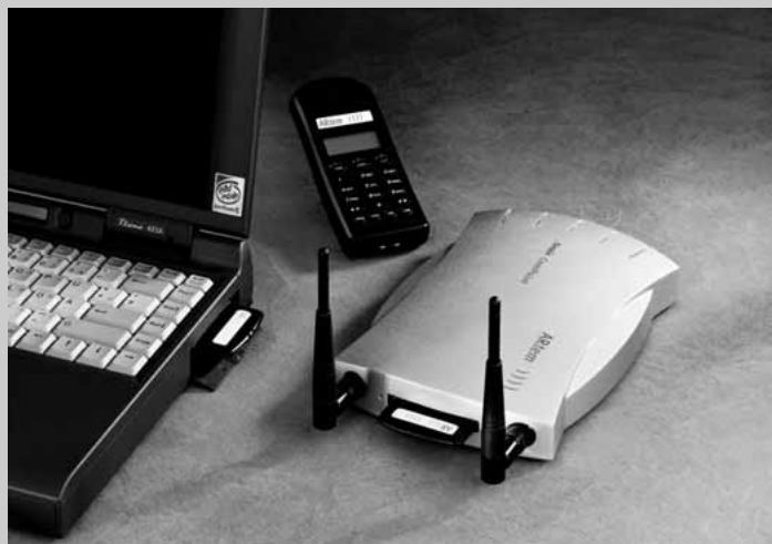
Oben links: Scharfschalten der Station mittels Transponder, Viterra; rechts daneben: 'Com-Point' zur Funkübertragung von Daten und Sprache, Artem
