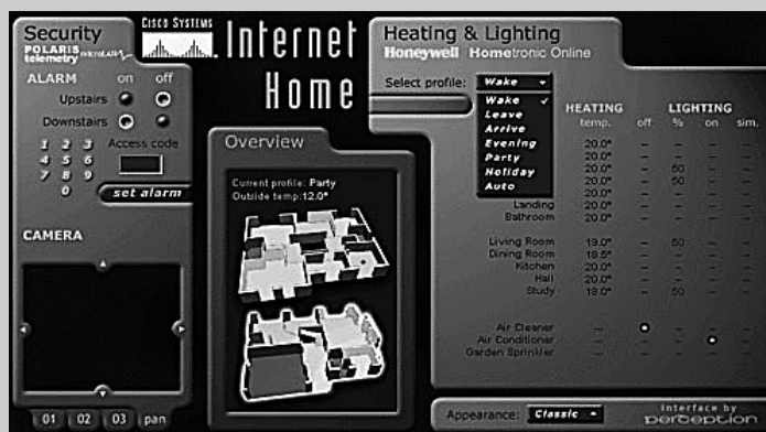
Oben: Ansicht Display zur Überwachung von Licht, Heizung u. Zugängen; Grafikoberfläche Modell 'classic'; darunter: Erdgeschoß und Obergeschoß 'Internet-Home'
