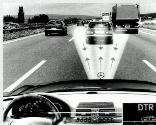
Links: Der Verkehrsfluß in Metropolen wird heute wie in Tokio über Leitsysteme geregelt. Kameras überwachen neuralgische Bereiche und Kreuzungen; oben: Automatisierte Abstandsregelung mit 'Distronic'
