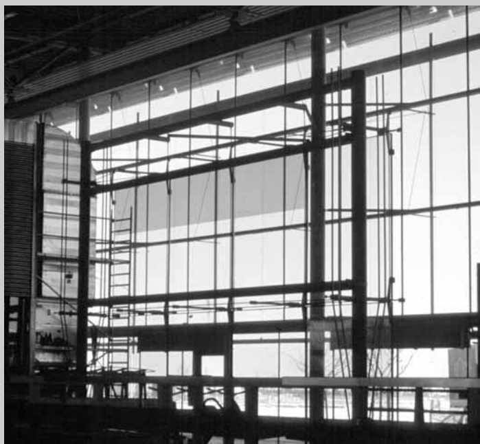
links: Gesamtansicht der Musterfassade, aufgebaut in der Produktionshalle von Seele; oben: Vertikalschnitt durch die Glashalter ('Spider') der Fassade
