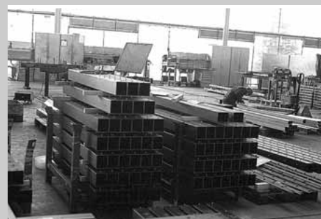
unten: Blechbearbeitungsabteilung mit Kantbänken, dazwischen Lagerung vorkonfektionierter Profile
