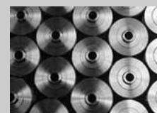
Obere und untere Seilklemmenteller sowie Seilumlenkrolle, Projekt Eingangsüberdachung West Expo Hannover, zur Zeit in Montage, Architekt: Ackermann + Partner, München
