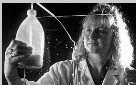
rechts: Verschmutzungsverhalten von Floatglas ohne und mit Antisoil-Beschichtung; unten: Easy-to-Clean-Beschichtung im Schmutzwassertest
