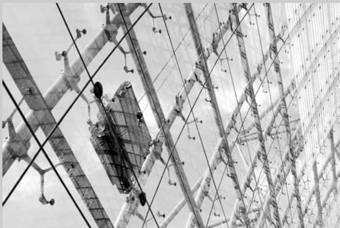
Oben: Scheibenreinigungsroboter beim Putzen auf der neuen Messe Leipzig. Rechts: Innenleben mit geöffnetem Gehäuse, daneben: Gerät für senkrechte Fassaden
