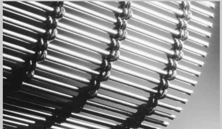
Oben: Technisches Metallgewebe ist in Kettrichtung biegsam, in Schussrichtung steif. Links: Schlammmentwässerungsanlage aus dem Bergbau.
