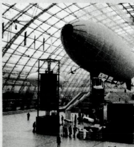
Oben: Die historische LZ 1XX am Ankermast. Darunter: Flugfähiges Funktionsmodell 'Joey' im Maßstab 1:8 mit Kielrahmen und Steuerkanzel für zwei Personen auf der Messe Leipzig. Rechts: das Flugfeld in Brand mit Bauhalle (links) und zwei Ankermastbereichen.
