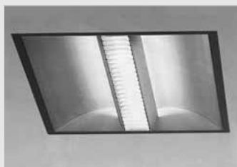
I/D-Einbauleuchte von Regent: Einbauleuchte für Kompakt-Leuchtstofflampen mit EVG, weiße Sattelreflektoren, patentiertes System zur werkzeuglosen Montage, unterschiedliche Lichtambiente durch fünf unterschiedliche Gegenreflektoren.
