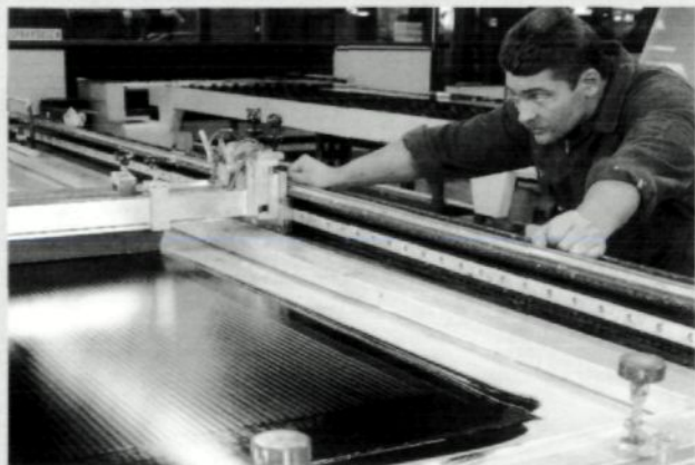
Von links nach rechts: Siebdruck nach Diavorlage im Werk Wesel der Flachglas AG, Vorver- bundenanlage unter Rein- raumbedingungen und Autoklav für die Herstel- lung von laminierten Gläsern
