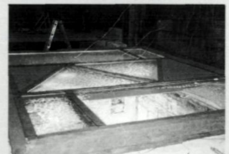
Brandschutzprüfungen, oben: Pyroswiss G 30 mit Siebdruck in Stahlrahmen; unten: als asymmetrische Isolierverglasung in Horizontalprüfung
