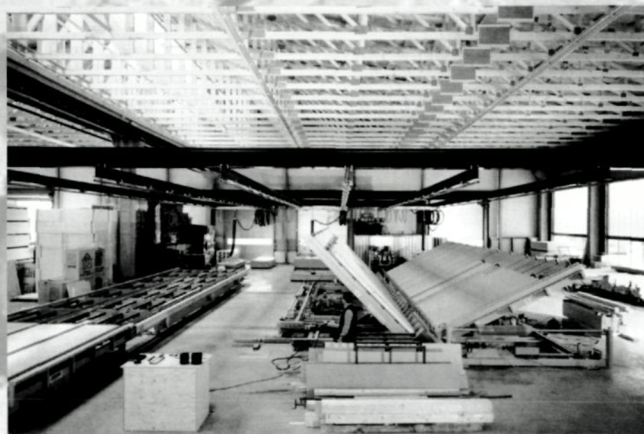
Witterungsunabhängige, individuelle Vorfertigung von kompletten Außenwandelementen: Aufnahmen aus der Produktionshalle des Holzbauunternehmens Opitz
