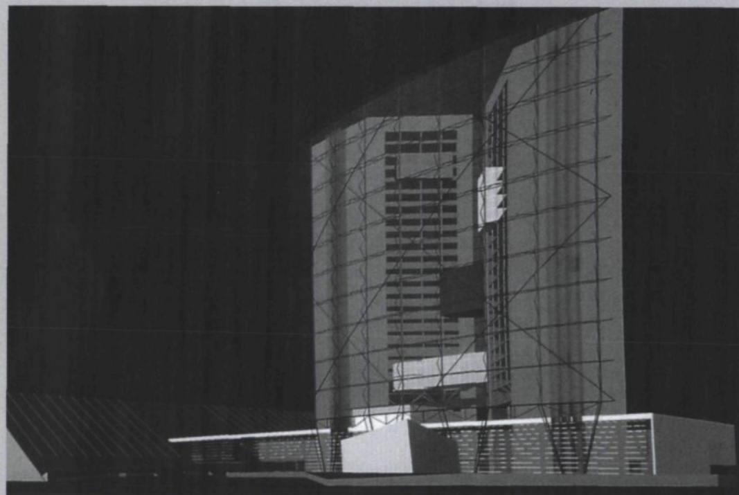
Hochhaus mit Klimaschirm. Der zweischichtige Aufbau des Klimaschirms mit großem Zwischenraum bietet Möglichkeiten der Energiegewinnung und -kontrolle.
