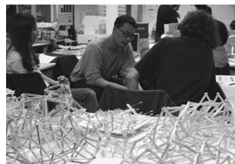
Projekt: Kinetetras – reagibles über Sensoren gesteuertes Raumfachwerk, oben: physische Modelle
