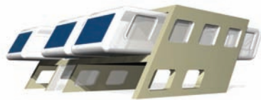
Der Entwurf von Robert Hortig beschränkt das Thema Solarhaus nicht allein auf die Anwendung von Photovoltaik und Solarthermie. Nach dem Motto "Schatz, schiebst Du mal das Haus auf zum Heizen?" können zur saisonalen und zur Tag-Nacht-Regulierung raumgroße Sonnenfallen ein- und ausgefahren werden, die zugleich das Verhältnis von Oberfläche zu Volumen verändern. Leider bleibt der Entwurf skizzenhaft und man vermisst Angaben zu Speichermasse oder transparenten Materialien.
