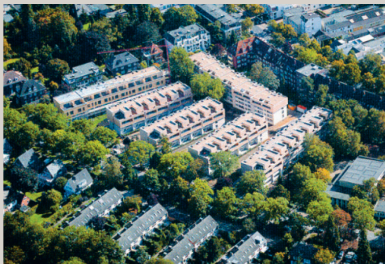
Entgegen den ursprünglichen Vorstellungen des Bauherrn konnte durch die Aufstockung der sechs zwei- und dreigeschossigen Baublöcke von 1959 der offene Charakter des Quartiers erhalten bleiben.
