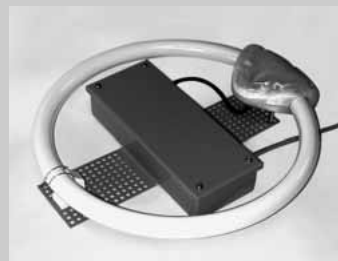
Beleuchtungseinheit mit Ringleuchtstoffröhre.
