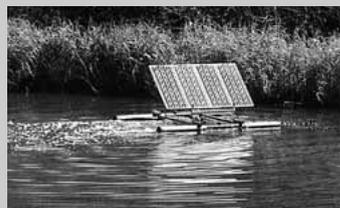
Oben: Im Belüftungsteich fest montiertes Rührwerk; darunter: auf spezieller Schwimmerkonstruktion montierte Anlage mit Solarantrieb für dezentralen Betrieb; rechts: Der eiförmige Rührkörper wird aus der Inversionsbewegung in Form einer räumlichen Acht abgeleitet. Sie ist Umhüllende zweier senkrecht aufeinander stehender Kreisflächen.
