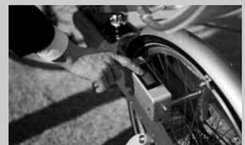
Oben: Elektronisches Schloß für Call-a-bike Räder mit LED-Anzeige und Bedienfeld am Hinterrad
