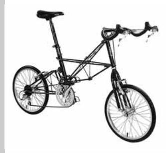
Dreiecke ausgenutzt und Torsionssteifigkeit durch Optimierung der Rohre und Verbindungen hergestellt. Komfortable Handhabung muß daher bei diesem Radkonzept stets mit einem Verlust an Steifigkeit erkauft werden. Ausgangspunkt für Alex Moultons Radkonzept ist dagegen ein Raumbauwerk mit kleinen Laufrädern bei Standard-Sitzposition.
